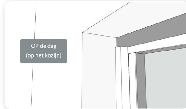
Plissé hordeur "op de dag" (op het kozijn)
